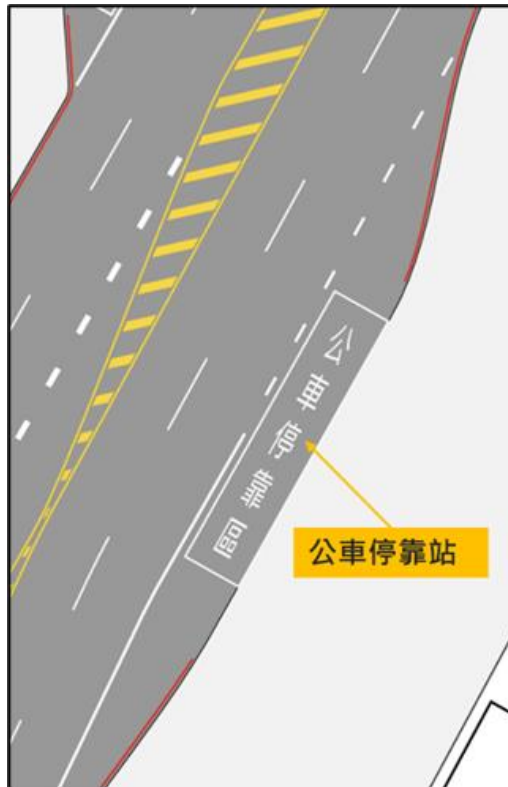
圖 5.1-5 公車停靠站設置圖例
