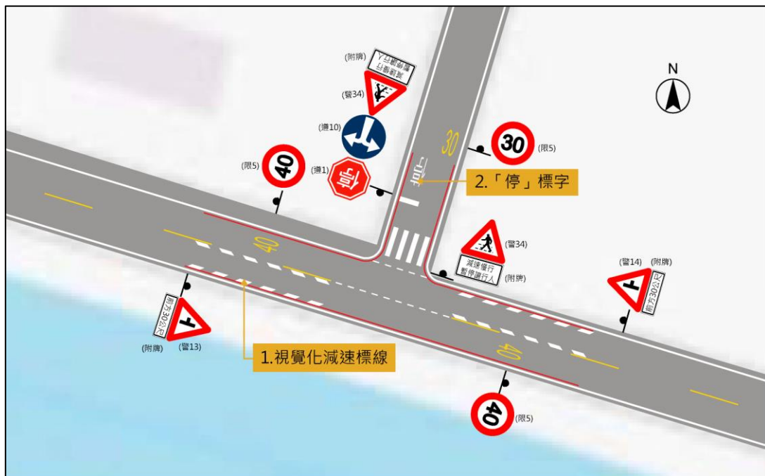
圖 2.2-1 無號誌鄉區正交三叉路口交通設施整體設置圖例
