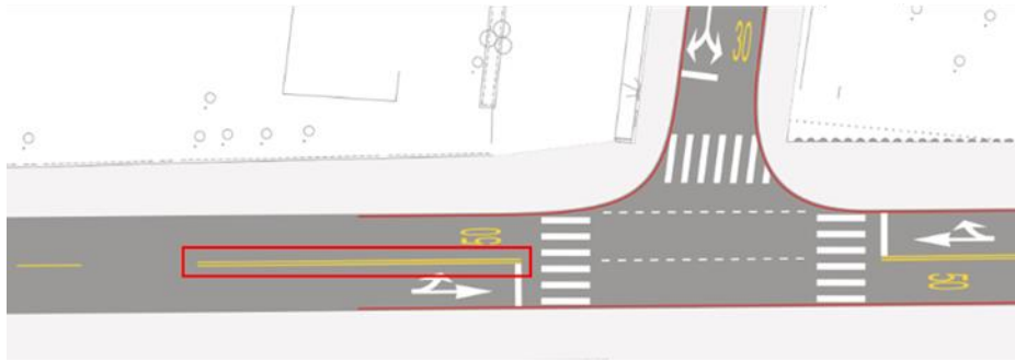
圖 3.2-2 分向限制線設置圖例-無中央分隔島
