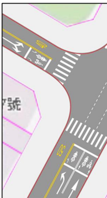
圖 3.1-3 速度限制標字圖例
