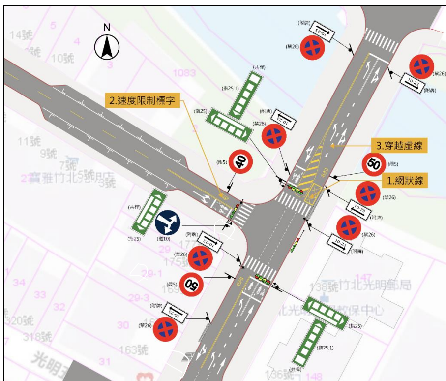
圖 3.1-1 號誌化市區正交三叉路口交通設施整體設置圖例
