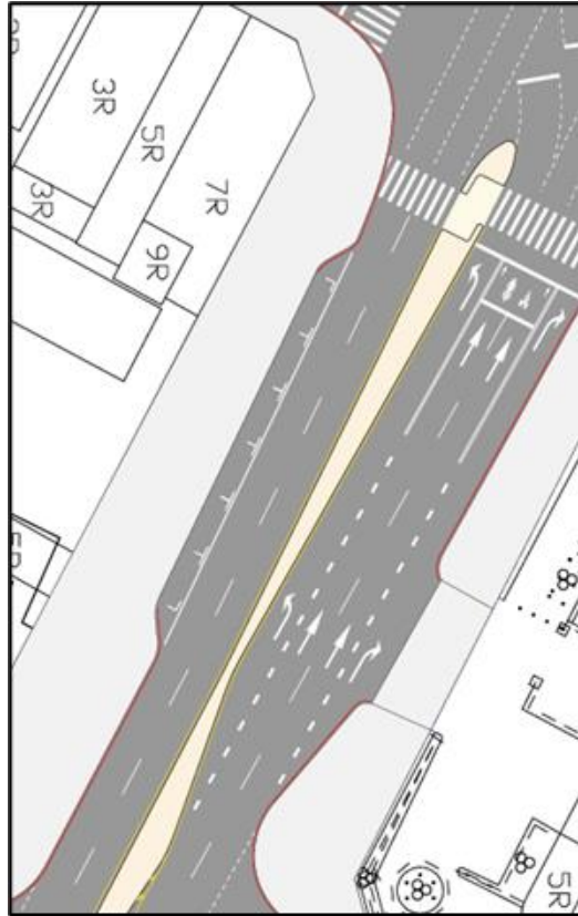
圖 5.1-4 穿越虛線圖例
