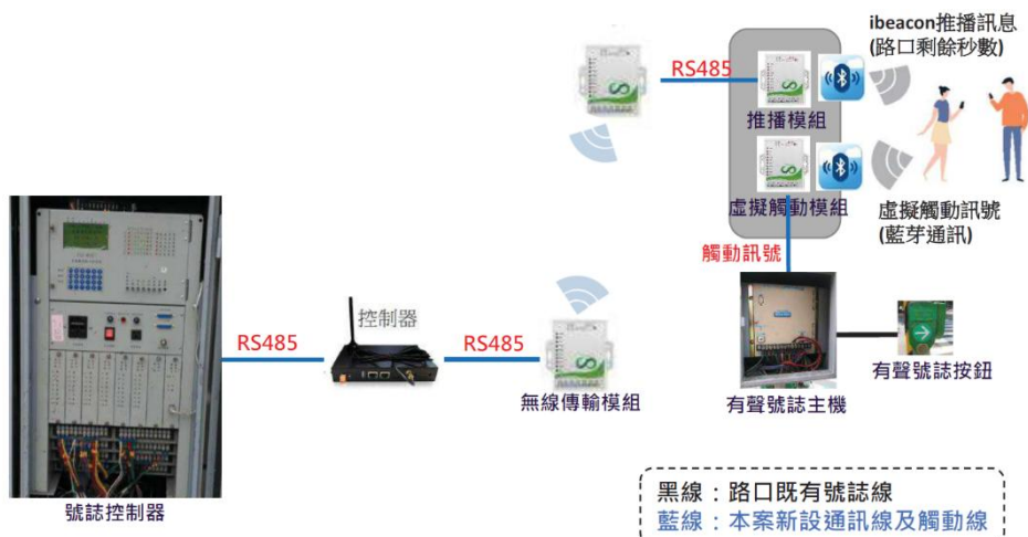
圖 3.2-2 臺北市輔助視障者通過路口服務-號誌控制器至藍芽推播模組採無線傳輸架構
